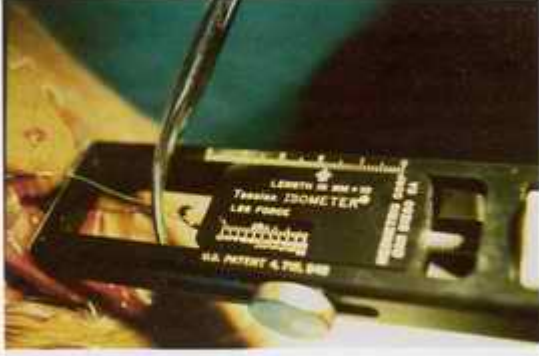
Resim 9: Tansiyon-izometri enstrümanına telin 8 kilopointlik gerilim altında tutularak ölçümlere hazırlanması.
